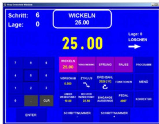
Das Wickeln ist nur in diesen zwei Fenstern erlaubt. Wenn beliebiges anderes Fenster geöffnet ist, Start des Zyklus wird blockiert.
