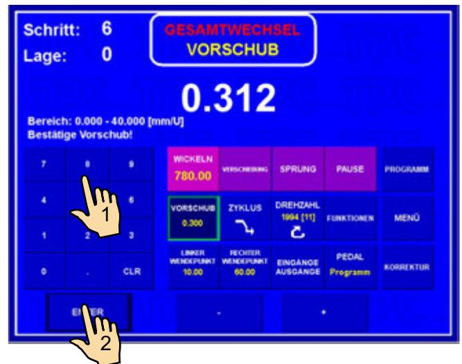
So wird Vorschub in allen folgenden Wickelschritten gewechselt werden.
