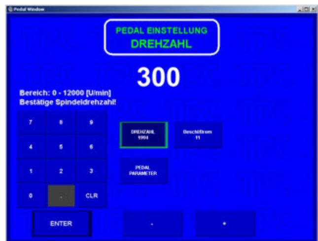
So eingestellte Drehzahl gilt für aktuelles Programm und hängt nicht von der einprogrammierten Drehzahl in einzelnen Schritten ab.
