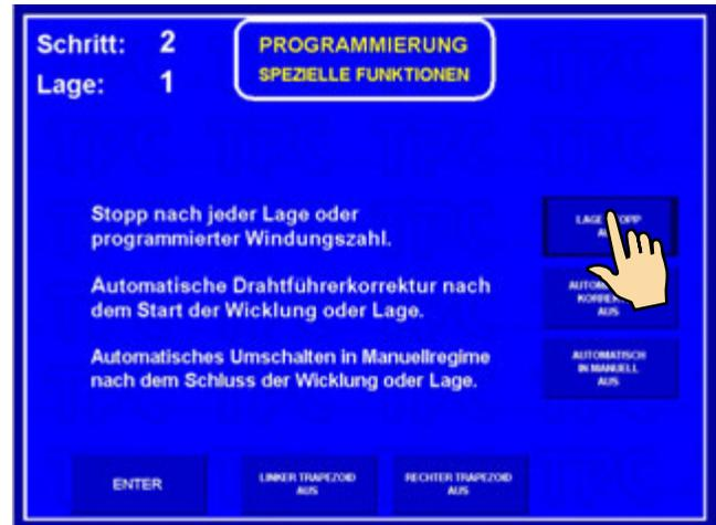
Die Wickelmaschine stoppt nach jeder gewickelten Lage auf dem linken oder rechten Wendepunkt. Durch Drücken der START-Taste oder mittels Pedal man wickelt immer eine Lage, bis einprogrammierte Windungszahl erreicht ist.
