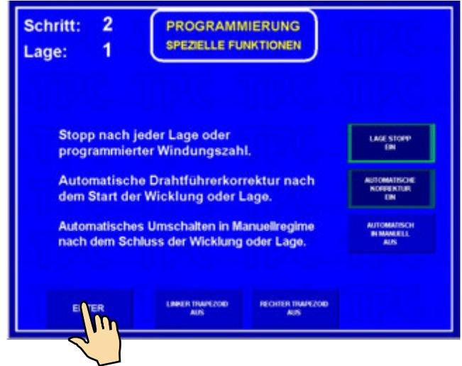
Nach der ersten Lage ( z.B. von links nach rechts ) man drückt die Korrekturtaste DRAHTFÜHRER POSITION und korrigiert nötige Drahtführerlage. Diese Lage speichern wir durch Drücken der Taste SPEICHERN WIE RECHTE KORREKTUR.
