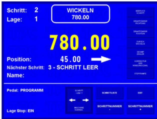
Maximaler Wert der Korrektur der Drahtführerlage darf nicht  $\pm 10$  mm von seiner Lage nach dem Wickeln überschreiten. Grössere Korrekturwerte werden nicht durchgeführt werden !
