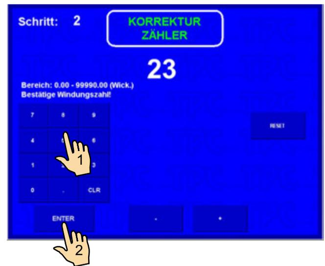
Durch Drücken der RESET - Taste man nullt der aktuelle Zählerzustand.
