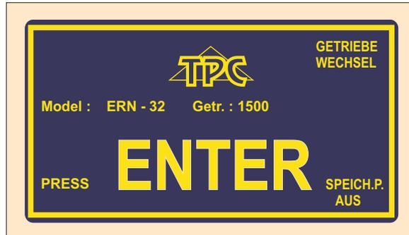
Leitfenster bietet Informationen, für welchen Typ ist die Steuerung eingestellt und Softwarenummer. In diesem Fenster kann man eingestellte Getriebe wechseln, die MUSS aber unbedingt mit der eingestellten mechanischen Getriebe STIMMEN.
