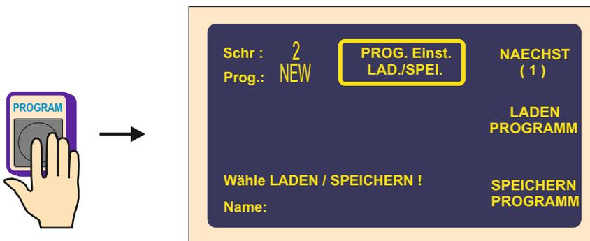
Nach dem Programmschöpfen empfehlen wir Programm zu nennen (Name, Wickelvorschrift). Das sichert den Überblick und schnelle Orientierung in gespeicherten Programmen. Max. Buchstabenanzahl ist 24. Wenn Programme auch auf USB-Schlüssel gespeichert werden, man empfiehlt max. Namenlänge in Format 8.3 - 3 Zeichen, Punkt und Beilage bis 3 Zeichen.
