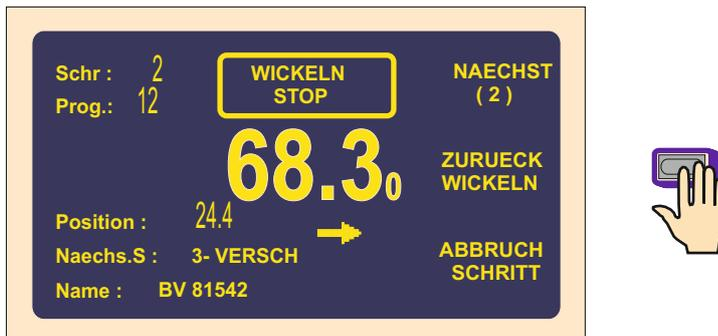
Jetzt können wir mittels Pedal geforderte Windungszahl abwickeln, wobei Windungszahl auf der Anzeige abgerechnet wird und Drahtführer kehrt sich zurück.
